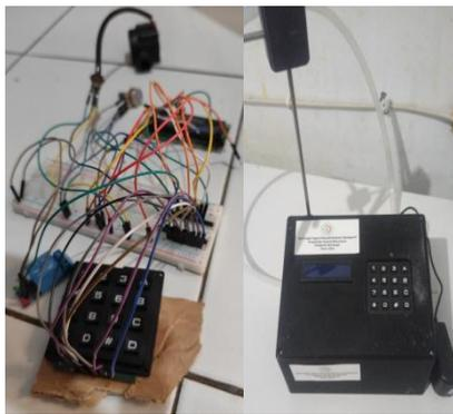
Gambar 4.2 Hasil rangkaian alat (kiri) dan setelah disempurnakan menjadi alat yang siap untuk digunakan (kanan)
