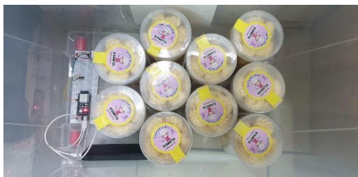
Gambar 3. Pengukuran suhu dan kelembapan kue kering dalam penyimpanan kontainer
