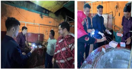
Gambar 8. Uji coba sensor pengukur suhu di bak pemasak bubur kedelai (lampu akan menyala jika air sudah mencapai suhu tertentu)
