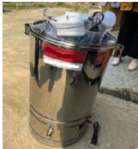
Gambar 3. Mesin penyaring bubur kedelai
