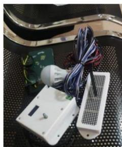
Gambar 5. Alat sensor pengukur suhu di dalam bak pemasakan bubur kedelai
